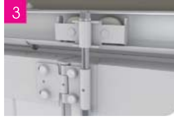
3 Galets tandem. Guidage de la porte par des double-galets montés sur roulement à billes pour un mouvement fluide, silencieux et durable.
