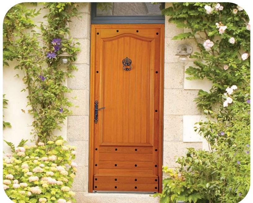
Dormant de 48 mm d'épaisseur / Ouvrant de 40 mm à recouvrement / Isolation renforcée par double panneaux polyuréthane / Seuil Aluminium 20 mm / Joint périphérique sur le dormant / Serrure 4 points à manœuvre automatique / 4 fiches à réglage tridirectionnel.
