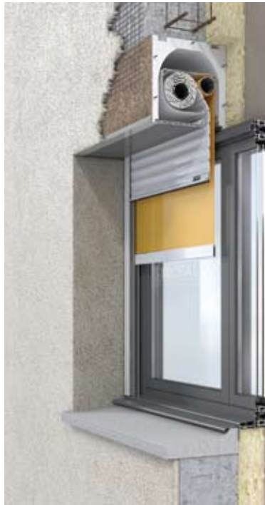
VOLET ROULANT TRADITIONNEL MONTÉ DANS COFFRE AVEC STORE OCCULTANT
